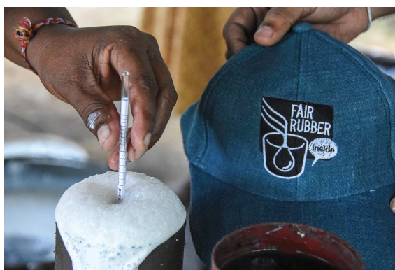
Abbildung: Messen des Gummianteils in der frischen Latexmilch
